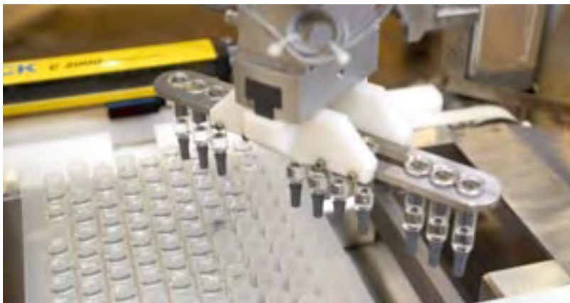
Createch Engineering ontwikkelde de pickinginstallatie voor een spuitentransportsysteem bij GlaxoSmithKline.
