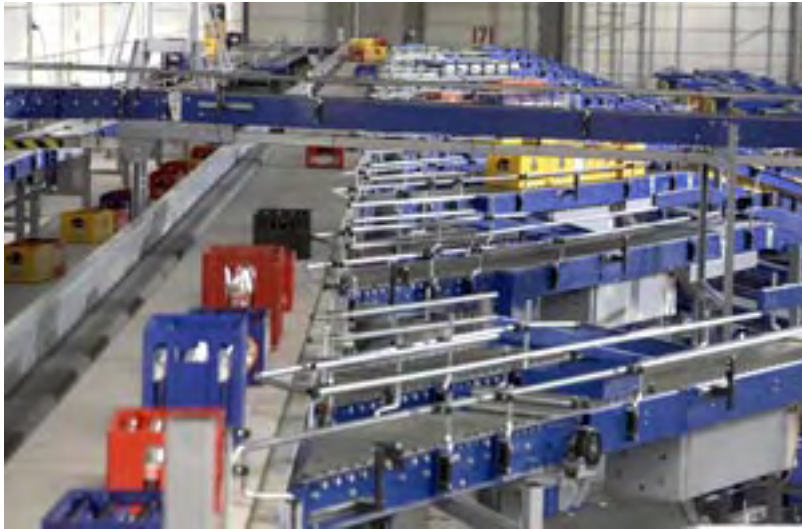
De 'Waldico sorter': sorteerlijn voor leeggoedbakken in Ghislenghien, ontwikkeld door Dolmen IP
